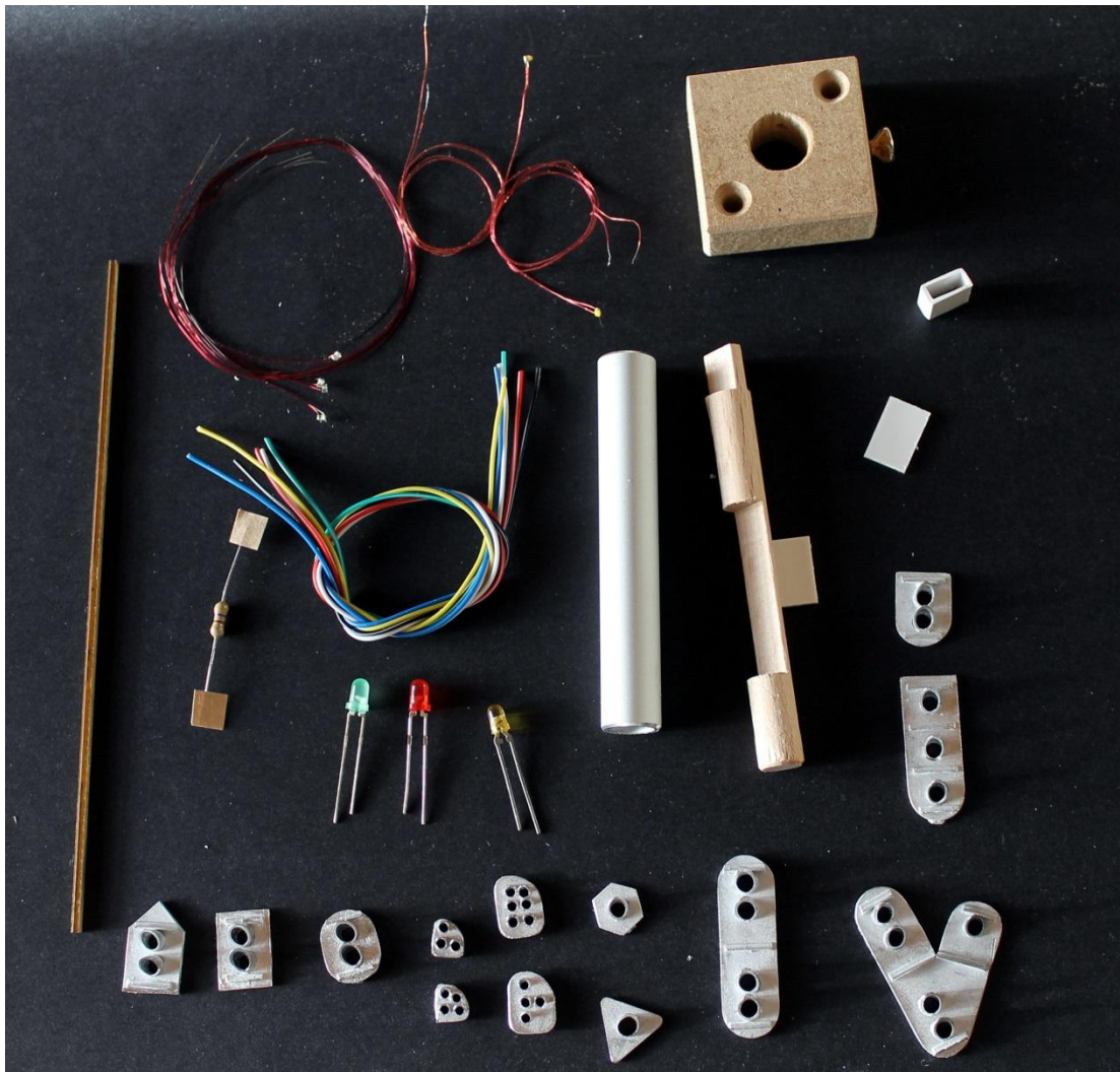
Figur 2. Banetjenestens signalbyggesæt. Her dog med flere dele end til ét signal. Indsatsen til DV er med tilpasset top.
